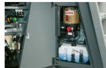
Запасният резервоар за системата за централно мазане и уредбата за миене на стъклата са добре видими от зоната на входното стъпало.
