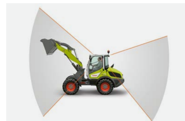
Свободна видимост върху цялото навесно оборудване
