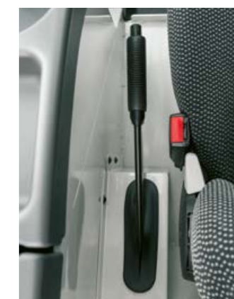
Механична паркираща спирачка вляво, до седалката на водача
