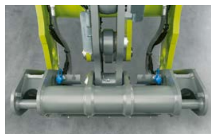
Всичко е подготвено за защитен монтаж на две хидравлични съединения за допълнителен управляващ кръг
