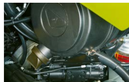
Прахоотделящият клапан отвежда надеждно мръсотията от въздушния филтър.
