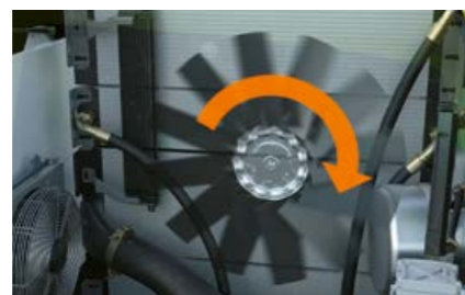
По посока на часовниковата стрелка: обратно издухване на въздух
