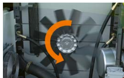
Обратно на часовниковата стрелка: засмукване на въздух
