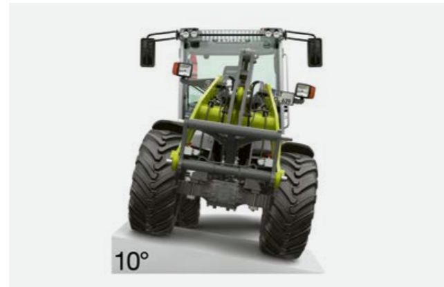
Стабилната шарнирна връзка с ъгъл на люлеене от 10° изравнява неравностите по земята и осигурява висока устойчивост и комфорт на движение.
