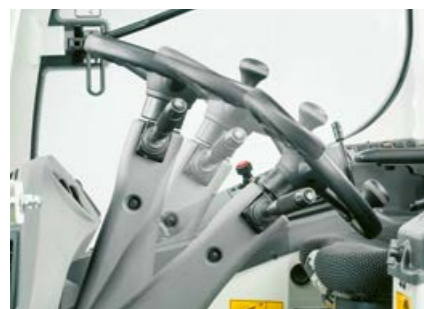
Безстепенна кормилна колона с регулируем наклон
