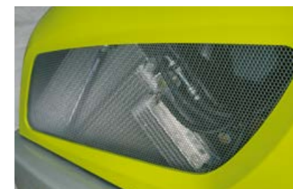
Голяма засмукваща повърхност на охлаждащия пакет
