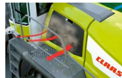
Отворите за засмукване и охладителят се освобождават от прах и замърсяване
