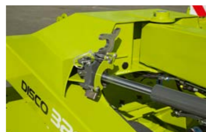
Гъвкаво: преместване на теглича без инструменти за бързо нагаждане към различни трактори (опция)
