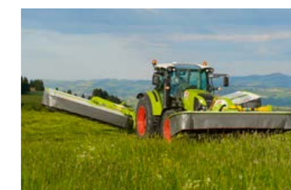
Поради компактното окачване на предния подежник, косачката е на голямо разстояние от браздата.
