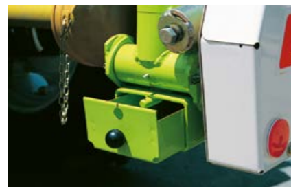
Интегрирана кутията с инструменти предоставя достатъчно място за всички материали, от които имаме нужда на полето, като остриета на ножове и гаечни ключове
