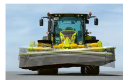
Регулиране напречно на посоката на движение поради свободно висящото окачване.
