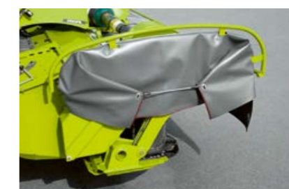
Поради ниско разположеният център на въртене DISCO PROFIL следва почвата, а не трактора.
