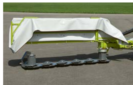
Сгъващите се защитни платна позволяват удобен достъп до всички точки за поддръжка.
