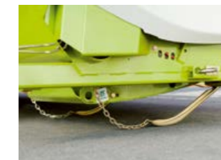
Сензорните скоби обхващат позицията на приставката за AUTO CONTOUR и CONTOUR.
