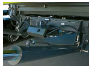
Двупътните цилиндри на приставката регулират прецизно налягането.
