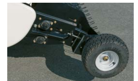
Сензорни колела осигуряват ограничаване на дълбочината.
