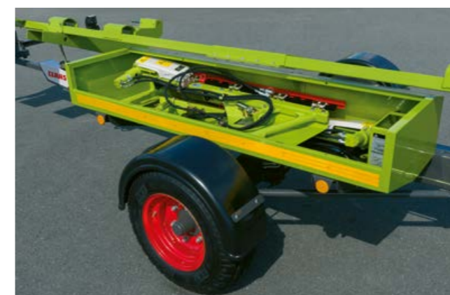
Заклучваща се транспортна кутия на транспортната количка за ножовете за рапица.
