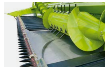
Водещ елемент с криволинейна траектория.
