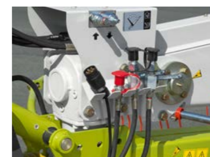
Серийно предлагано хидравлично следящо управление за преместване по предварително зададено време между предния и задния ротор при повдигане и спускане.
