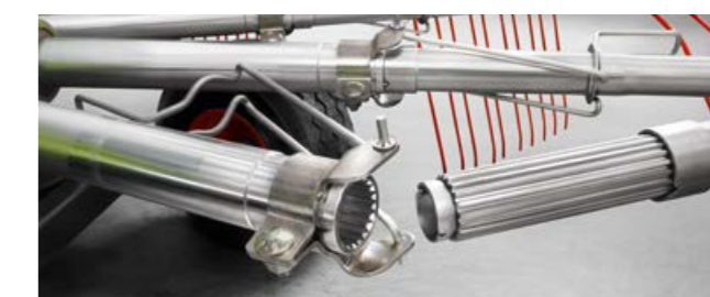
Патентованото обезопасяване на носачите PROFIX с много зъбци: удобен монтаж и демонтаж на палцовите носачи.
