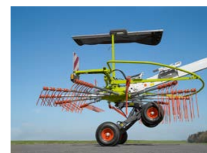
Голяма подемна височина преминаване над откоси при завой на бразда: до 50 см при LINER 700 TWIN.
