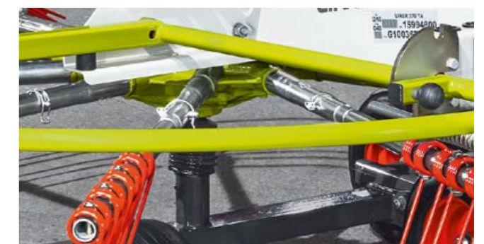
Съединение с овален профил и затягащ шплинт при LINER 370 и 320.
