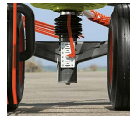
Останете гъвкави: Скала за регулиране на височините на захват
