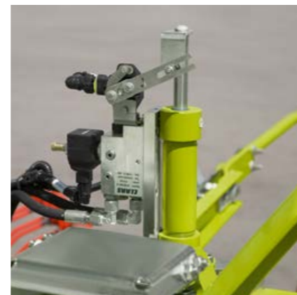
Двете четирироторни сеносъбирачки са налични като комфортен модел с хидравлично регулиране на височината на захват.
