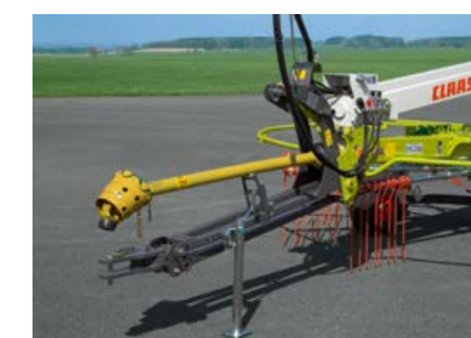
Паралелограмен теглич, предлаган като опция, при LINER 700 TWIN и серийно при LINER 800 TWIN.
