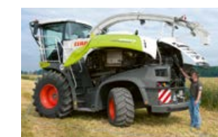
Почистване със сгъстен въздух
