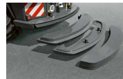
Гъбкавото задно баластиране обезпечява допълнителна защита на JAGUAR от сблъсък.
