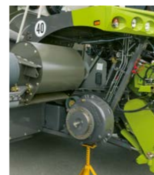
Бърз демонтаж на ускорителя
