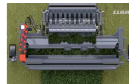
Подбирачът, PFS и ролковият притисквач се грижат за оптимален поток на материала.
