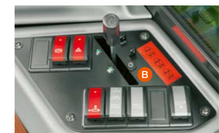
Лост за управление (В) за превключване на вида управление в базовия клас.
