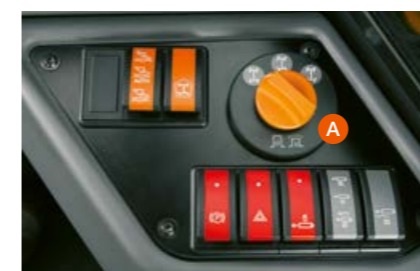
Въртящ се пневматичен прекъсвачел (А) за избор на вида управление при SCORPION VARIPOWER.
