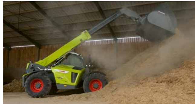
Дори при работа в изключително запрашена среда не съществува опасност от намаляване на мощността за охлаждане.
