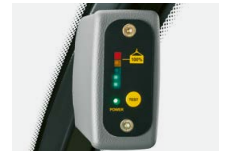
Индикатор на натоварването с ясна светлинна сигнализация: при преминанаване на границата на стабилност светват всички диоди и прозвучава алармен сигнал.
