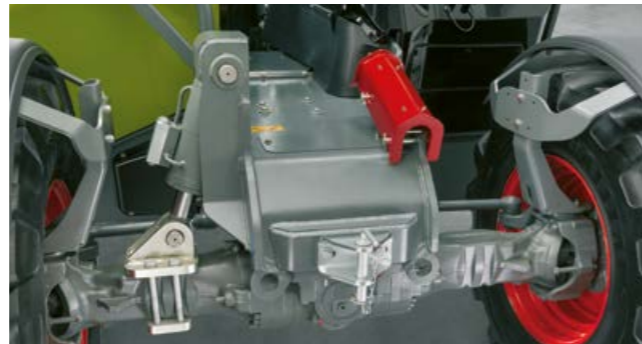
Повече сигурност върху терена благодарение на хидравличното изравняване на нивото
