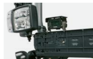
Камера отпред в дясно с висока резолюция предоставя контрастни изображения и при остатъчна светлина.
