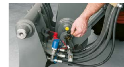
Контактни кутии за гъвкаво електрозахранване на различни приставки и навесно оборудване
