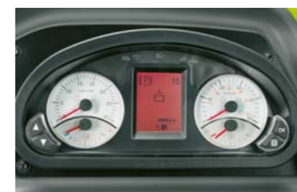
Комбиниран индикатор в базисния клас с монохромен дисплей.
