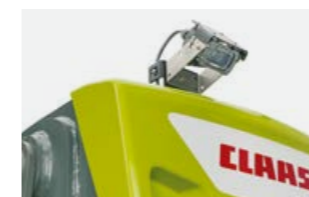
Камерата PROFi CAM отзад вижда всичко, което се случва зад гърба на водача.
