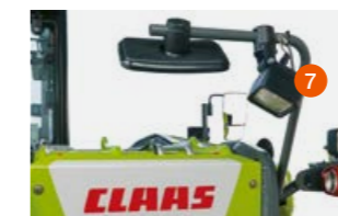
Халогенен фар на държача на задното огледало за осветяване на пространството зад машината.
