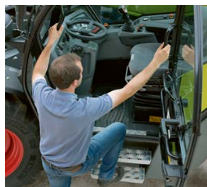
Лесен достъп до седалката на водача с възможност за индивидуална настройка на работната позиция.
