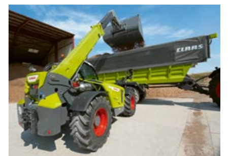
Системата за претегляне позволява прецизното пълнене на транспортни автомобили.
