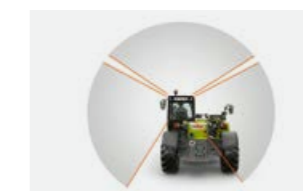
Безпроблемен поглед назад за по-добра експлоатационна надеждност чрез ниско шарнирно присъединеното телескопично рамо
