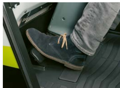
Спирачният педал със старт/стоп функция намалява разхода на гориво и износването на спирачките.
