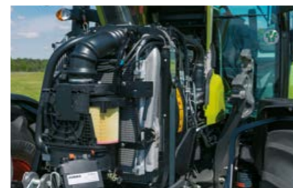
Лесно сваляне на филтъра на двигателя преди охлаждащите.
