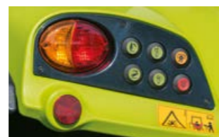
Възможност за обслужване от клапан с електронно управление на двата калника.
