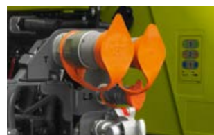
По-сложните от хидравлична гледна точка прикачни уреди се захранват от системата Load Sensing чрез връзките Power Beyond.
