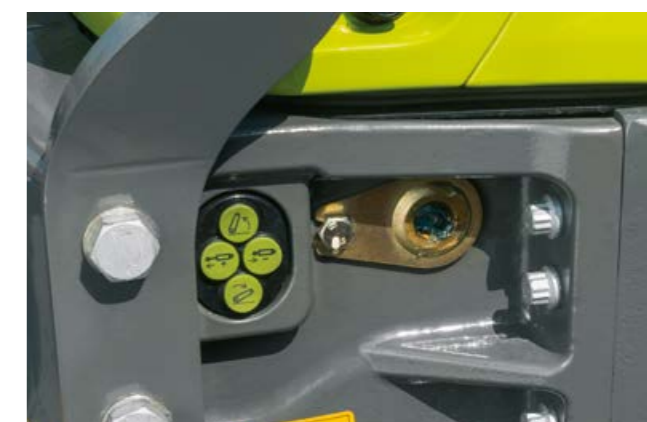
Предният подежник и допълнителния уред за управление могат да се обслужват и външно чрез клапани с електронно управление.
