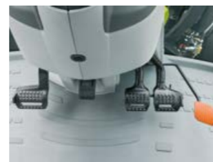
Кормилната колона се накланя автоматично чрез обикновено настъпване на средния педал и дава възможност за удобно слизане.
