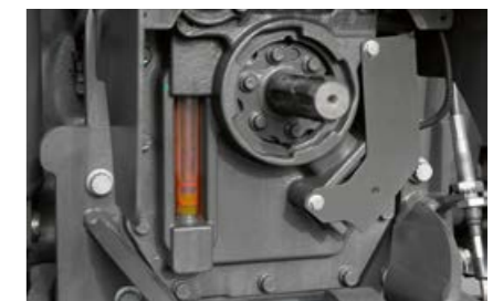
Лесен контрол на нивото на маслото на предавателната кутия и хидравликата от стъклото до силоотводния вал.
