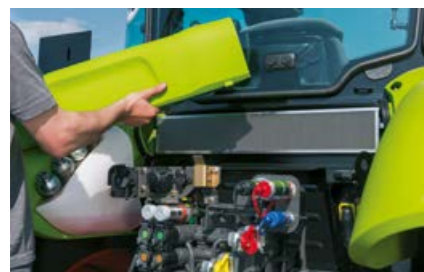
Лесен достъп до кабинния филтър зад кабината.
