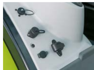
Връзки ISOBUS в кабината и в задната част
