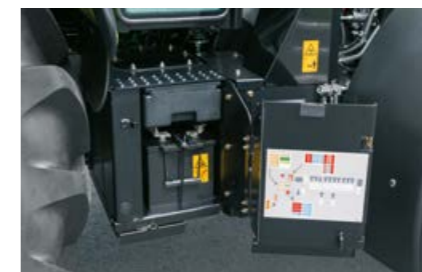
Отдясно на стъпалата, лесно достъпни, се намират батерията и отделение за прибиране на инструментите.
