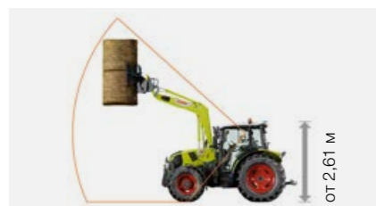
Кабина PANORAMIC с непрекъснато предно стъкло до стъкления покрив: габаритна височина над 2,61 м.
