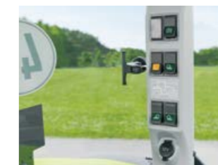
Обслужването на работните светлини за удобство е обединено в левия среден отсек.
