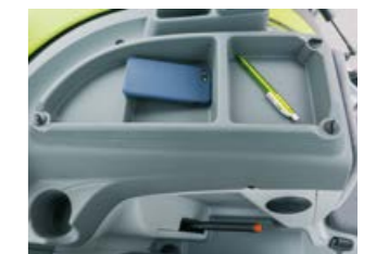
Всичко е на една ръка разстояние, благодарение на отделенията за съхранение на лявата странична конзола. За зареждане на мобилен телефон е налична връзка 12 V.
