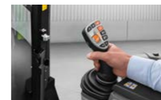
Обслужването на електронните клапани за управление става чрез пропорционалните превключватели на страничната конзола и интегрирания в мултифункционалния лост ELECTROPILOT.
