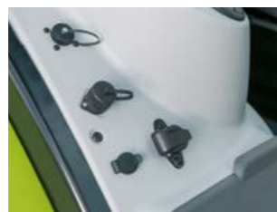
В кабината са налични връзки за електричество и терминали, съвместими с ISOBUS.
