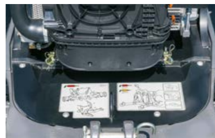
Под капака на двигателя се намира план за смазване, който улеснява работите по техническото обслужване.
