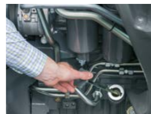
Щеката за маслото на двигателя е лесно достъпна дори при монтиран челен товарач.
