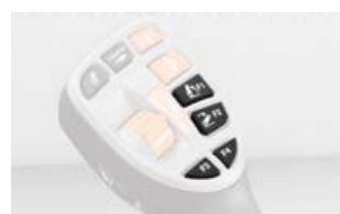
Последователностите на действие CSM се активират удобно от функционалните бутони на мултифункционалния лост за управление.
