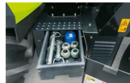
Отдясно на стъпалата, лесно достъпни, се намират батерията и отделение за прибиране на инструментите.
