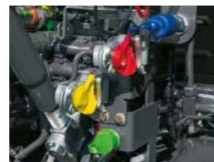
Пневматичната спирачна система и хидравличната спирачка са възможни и в комбинация.
