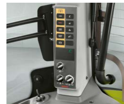
Скорости на силоотводния вал и електронно регулиране на задната навесна система с настройка от средния отсек
