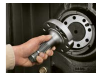
Лесна смяна на накрайника на силоотводния вал
