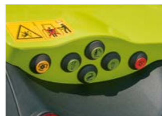
Външно обслужване на задния силоотводен вал върху двата калника
