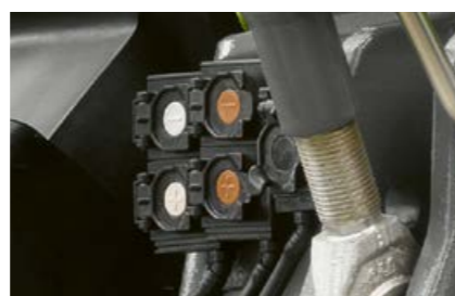
Във връзка с предния подежник се предлагат до четири хидравлични връзки и един свободен обратен поток в предната част. Идеално за предно окачване на бункер за семена или гребло.
