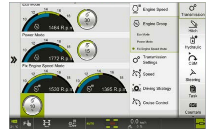
Настройка на натоварването на двигателя за режими „Eco“ и „Power“, както и на паметта за оборотите на двигателя
