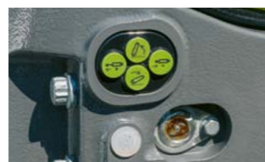
Външно обслужване на предния подежник и един уред за управление с оборудване CEBIS
