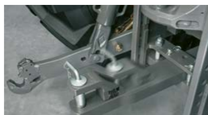
При вариантите за прикачване са възможни няколко позиции. Изтеглената позиция дава възможност за по-добра маневреност.
