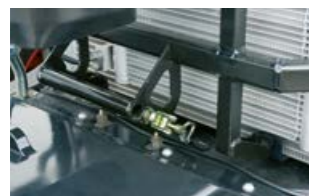
Места за смазване на предния мост пред охлаждащия пакет за оптимален достъп
