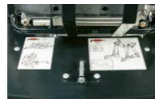
Под капака на двигателя се намира план за смазване, който улеснява поддръжката.
