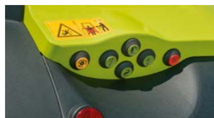
Външен обслужващ елемент за задна навесна система, силоотводен вал и управляващ уред по избор (само CEBIS).
