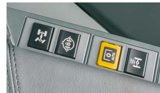
Активиране на амортизаторите на предния мост
