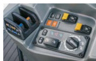
Имате възможност да избирате между механичното и електронното управление на задната навесна система. И двете са ергономично разположени вдясно до седалката на водача.
