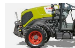
Сгъваемата предна навесна система позволява чрез ограниченото нависване сигурно маневриране при обръщане на обръщателната полоса.
