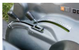
Имате възможност да избирате между механичното и електронното управление на задната навесна система. И двете са ергономично разположени вдясно до седалката на водача.
