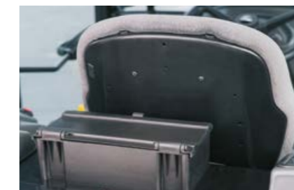
Въпреки тесното пространство всеки трактор NEXOS може да бъде оборудван с кутия с инструменти.
