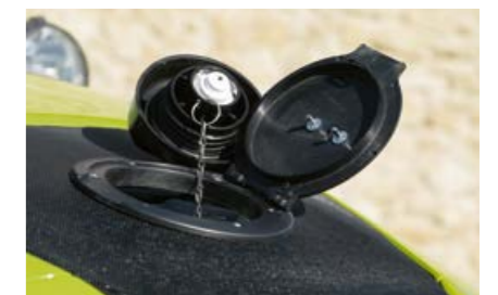
Регулируемият на височина отвор на моторния отсек е изключително практичен. Това позволява лесно отваряне и пълнене на защитено разположения отдолу резервоар.
