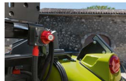
Разединителят на батерията се намира в задната част на кабината и е лесно достъпен.
