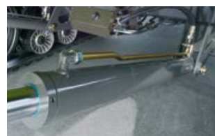
Двупътните цилиндри на хедера регулират прецизно налягането.
