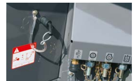
Точка за сервизиране за изпускане на маслата непосредствено до отделението за инструменти
