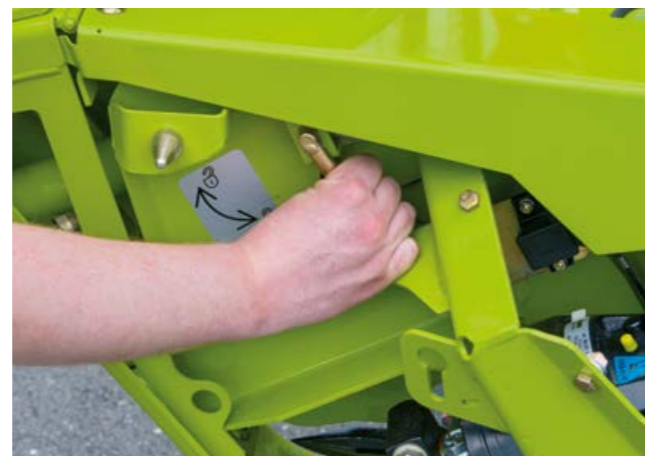
Фиксиране на делителите и ножовете за рапица с бързодействащ затварящ механизъм без инструменти
