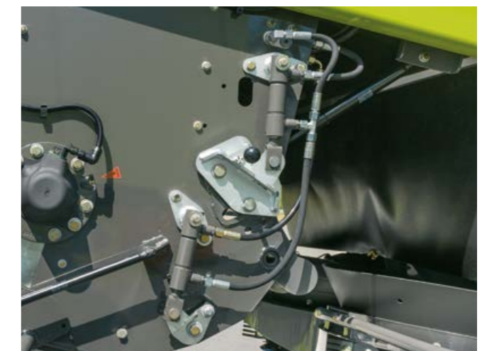
Хидравлично преместване на гребена на контраножа и триещия елемент
