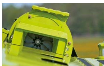
За добра видимост: прахоотвеждане на наклонената камера
