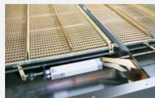
Електрическо преместване на ситата
