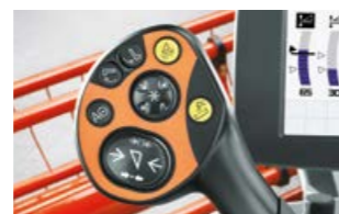
С бутона на мултифункционалния лост за регулиране на височината можете лесно да активирате автоматиката на хедера.
