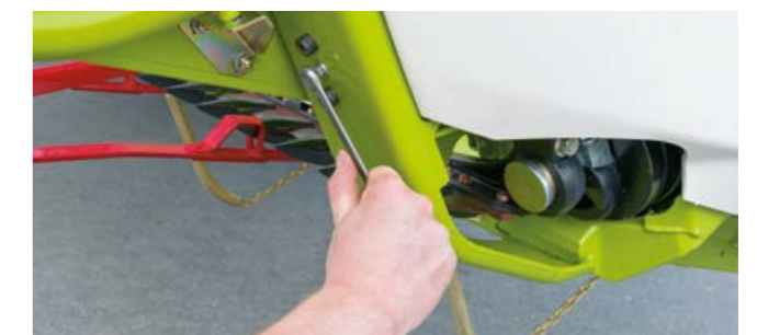
Лесна промяна на височината на делителя с ключа на клапана
