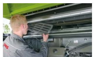
По-бърза смяна на сегментите, благодарение на коша MULTICROP.
