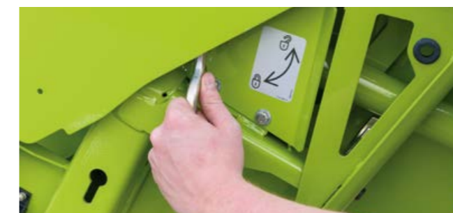
Фиксиране на делителите с бързодействащ затварящ механизъм без инструменти
