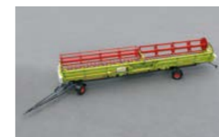
2-осева транспортна количка с водим заден мост
