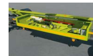
Заклучваща се транспортна кутия на транспортната количка за ножовете за рапица
