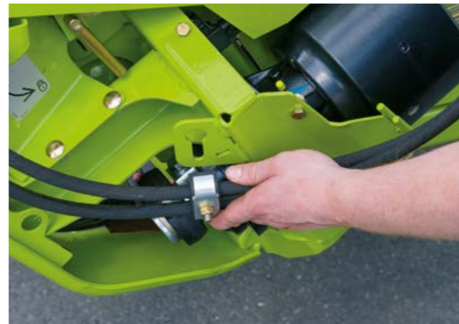
Лесно окачване на хидравличните маркучи за задвижването на ножовете за рапица
