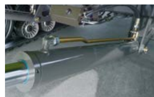
Двупътните цилиндри на хедера регулират прецизно налягането.
