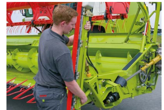
Монтаж на ножовете за рапица с помощта на механизъм за бързо затваряне
