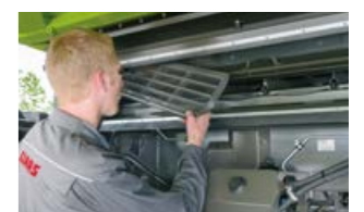
Бърза смяна на сегментите, благодарение на коша MULTICROP
