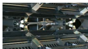
Хидравлично регулируеми роторни клапи за адаптиране на отделящата повърхност на ротора
