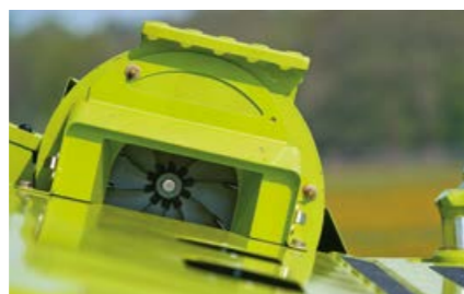
За добра видимост: прахоотвеждане на наклонената камера
