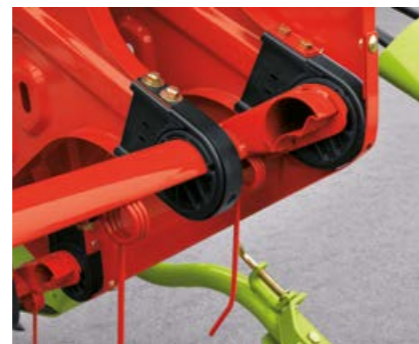
Пластмасови носачи и лагери за палците на мотовилото с оптимизирана форма за по-малко поемане на слама
