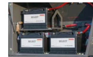
Две батерии за електрониката от 24 волта на двигателя, една за бордовата електроника с 12 волта
