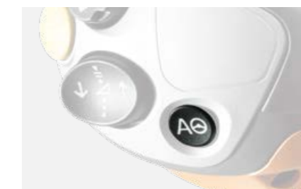
Лесно активиране чрез бутона AUTO PILOT на CMOTION или чрез мултифункционалния лост
