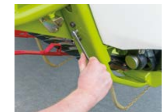
Лесна промяна на височината на делителя с ключа на клапана
