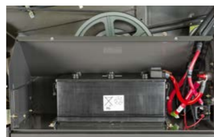
12 волта захранва бордовата електроника и електрониката на двигателя. Разположена на лесно достъпно място в кутията на батерията.
