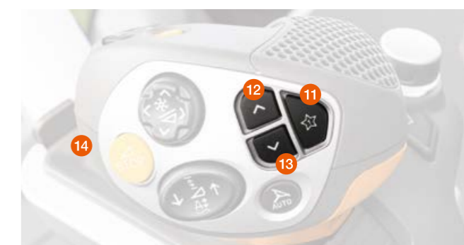
Лост за управление CMOTION: Избор на Фаворити (11), избор на Фаворити нагоре (12), надолу (13), коригиране на стойността през бутон (14)
