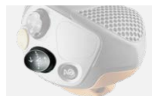
Активиране на регулирането на височината на рязане (AUTO CONTOUR), налягането на притискане и избор на височина на рязане, както и повдигане/сnižаване на приставката директно от мултифункционалния лост SMOTION
