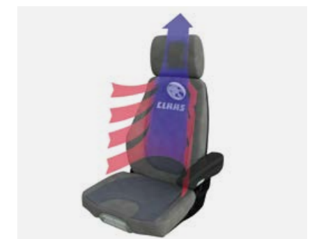
Премиум седалка с пневматично окачване с активен климатичен контрол
