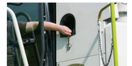
Хидравлична настройка на изхода на вършачната контра
