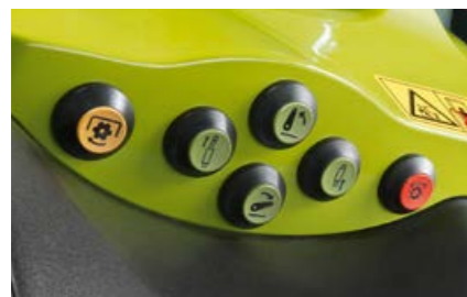
Външни обслужващи елементи за задната навесна система, силоотводния вал и един уред за управление по избор.
