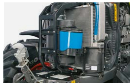
Въздушният филтър на двигателя разположен директно пред охладителя може много лесно да се достигне от земята.
