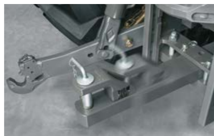
Вариантите с лост за прикачване предлагат повече позиции. Изтеглената позиция дава възможност за по-добра маневреност.
