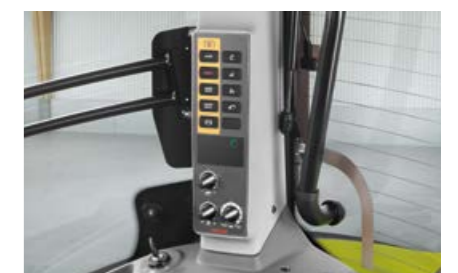
Скорости на силоотводния вал и електронно регулиране на задната навесна система с настройка от средния отсек.
