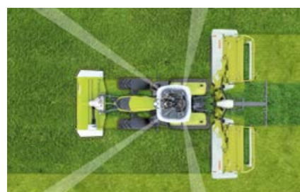
Чрез специалната подредба на задните конзоли на кабината и извитото задно стъкло, водачът получава оптимална видимост към работния уред и прикачването.
