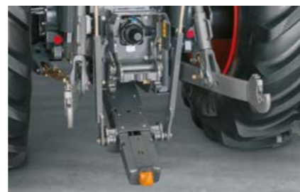
Тегличът с кука е наличен като алтернатива на теглича отговарящ на стандарта ISO-500.
