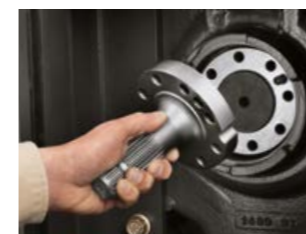
Лесна смяна на накрайника на силоотводния вал.
