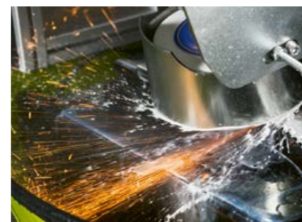
Чрез винаги правилния ъгъл на шлифване се запазват първоначалния радиус и контур на ножа.
