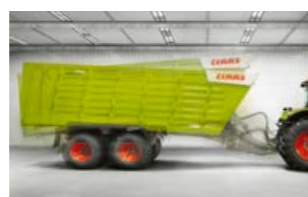
Хидравличният теглич позволява максимално повдигане и спускане на цялото ремарке.
