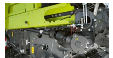
Задвижване на дозиращите валци.
