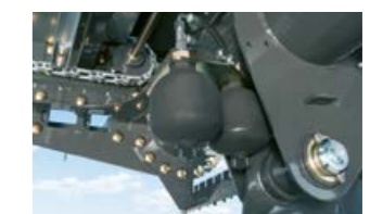
Хидравлични цилиндри за предлаганото като опция окачване на теглича.
