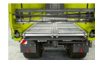
Комбинацията от два мощни хидромотора и двустепенно задвижване гарантират бързо разтоварване.
