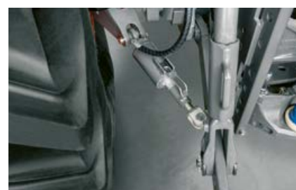
Опционалните хидравлични странични стабилизатори осигуряват по-голяма безопасност и улесняват работата.
