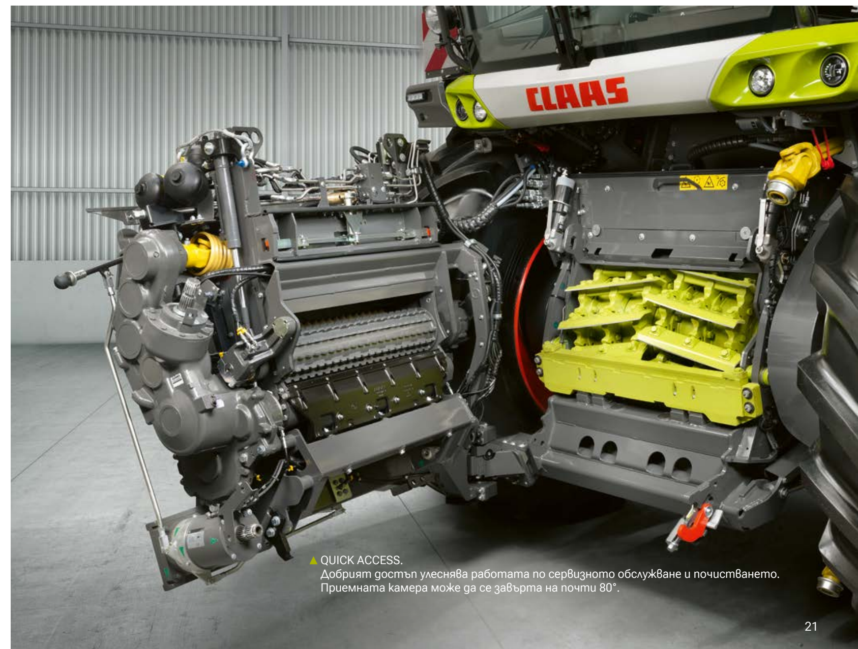
▲ Люлеещата се рамка осигурява активно (хидравлично) или пасивно (плаващо положение) регулиране на страничното балансиране, за оптимално приспособяване на приставките към терена.
