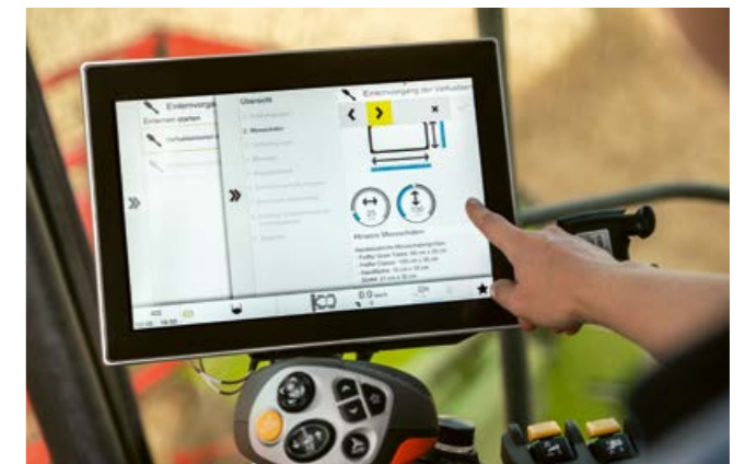
Въвеждане на измерванията на наличната тавичка за определяне на загубите в CEBIS
